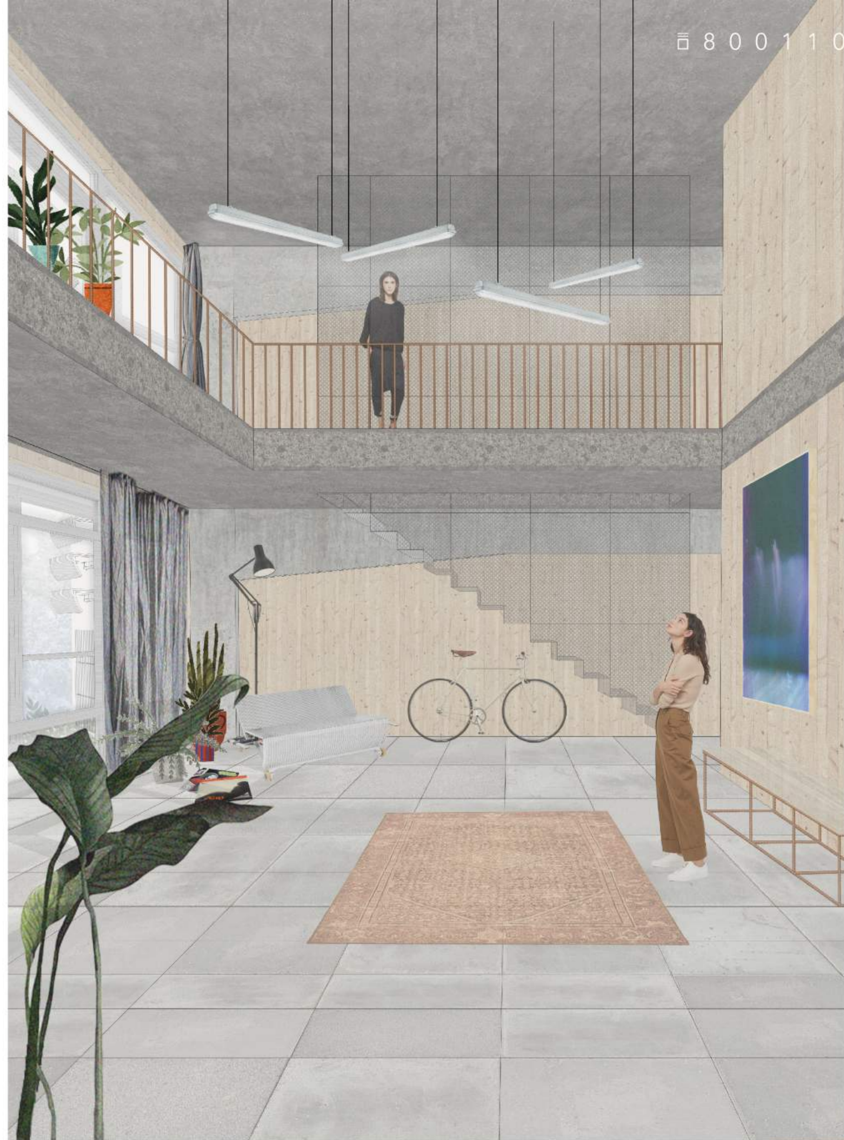
Lounge Chair aus Rolltreppenstufen | Treppenaufgang aus Lochblech | Fußboden aus Betonplatten | Brüstung aus Bewehrungsstahl | Sitzbank aus Bewehrungsstahl mit Holzletzen aus Pflanzkübeln | Wannenleuchten, abgehängten | Vorhang aus Marken-Textil
